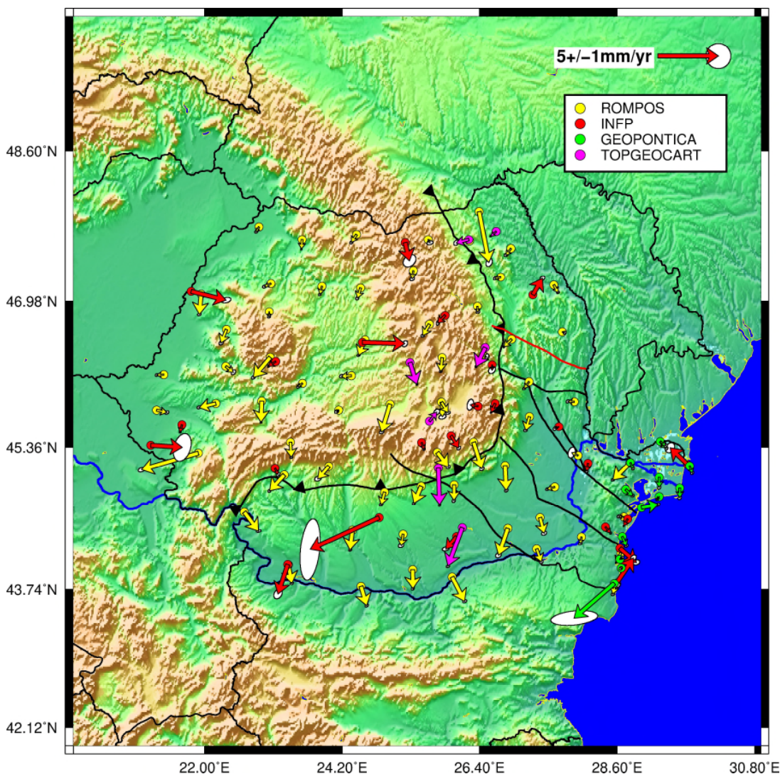
Figura 7: Vectorii mișcării orizontale cu elipsa erorii 2-sigma obținuți din observațiile GPS
