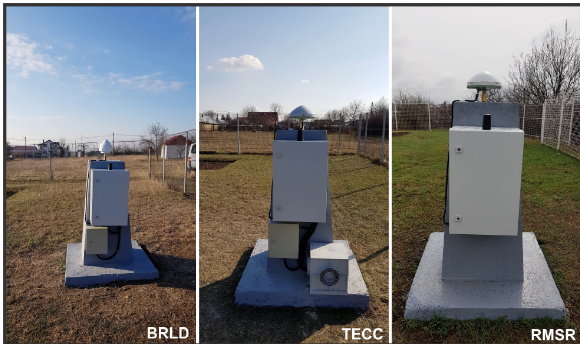
Figura 3: Stații GNSS Permanente de referință a INFP, extindere 2019
